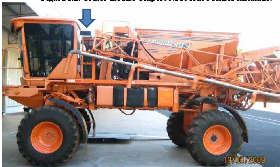
Figura 5.2: Trator modelo Uniport NPK com o sensor instalado.
