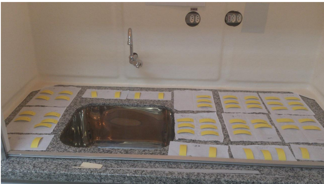
Figura 4. Disposição dos papéis hidrossensíveis colocados no interior da capela de exaustão de gases para secagem e posterior análise.
