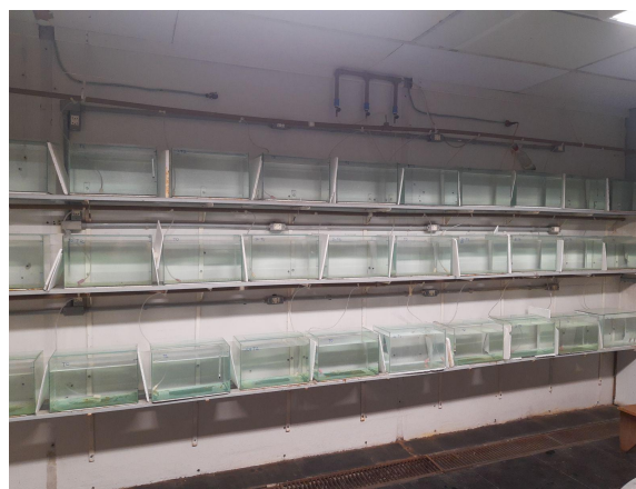
Figura 2 e 3. Imagem da disposição da sala de experimentos e aquários que continham um sistema de aeração via pedra porosa e barreiras físicas de isopor para impedir a visualização de coespecíficos. Fonte: Elaborado pela autora.
