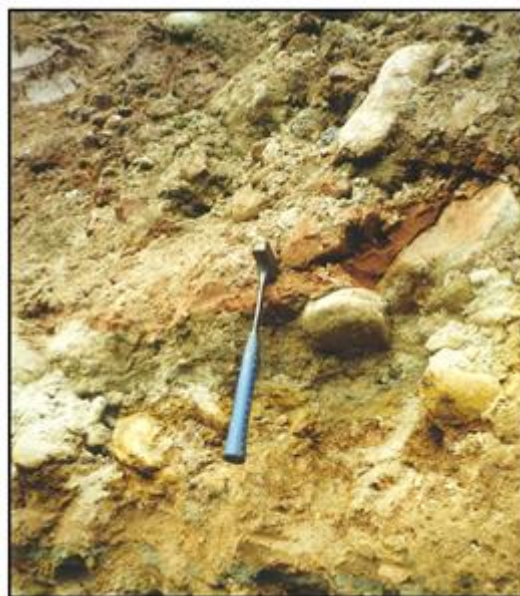
Figura 11 - Depósito de debris flow com seixos decimétricos em encosta da Serra do Mar (ALBERTO, 2010).
