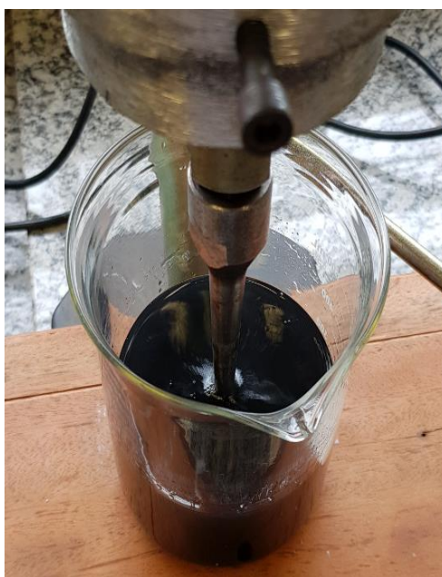
Figura 29: Mistura DMF-NTC no processo de sonicação.
