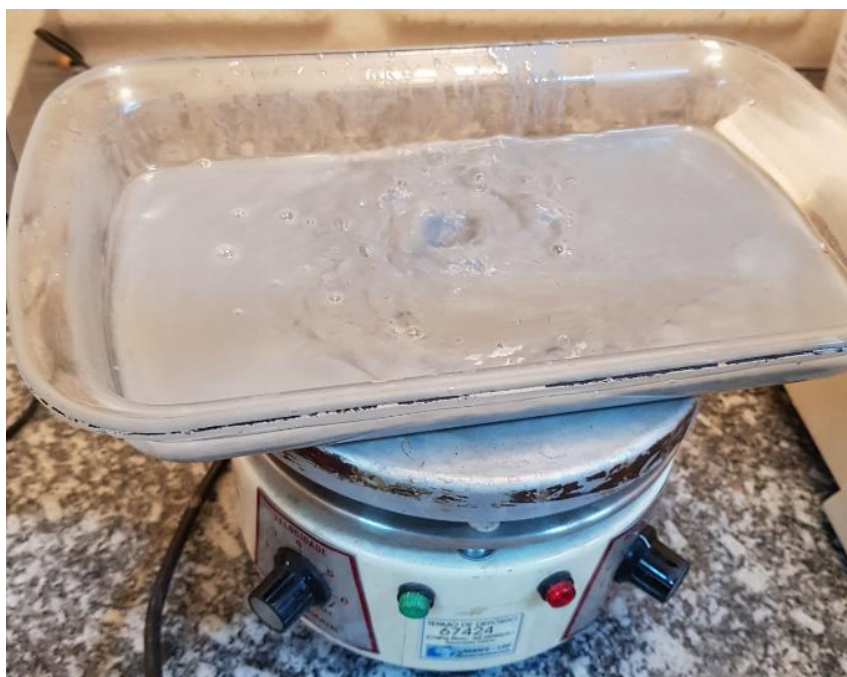
Figura 31: Mistura úmida no aquecedor de placa quente com agitação constante.
