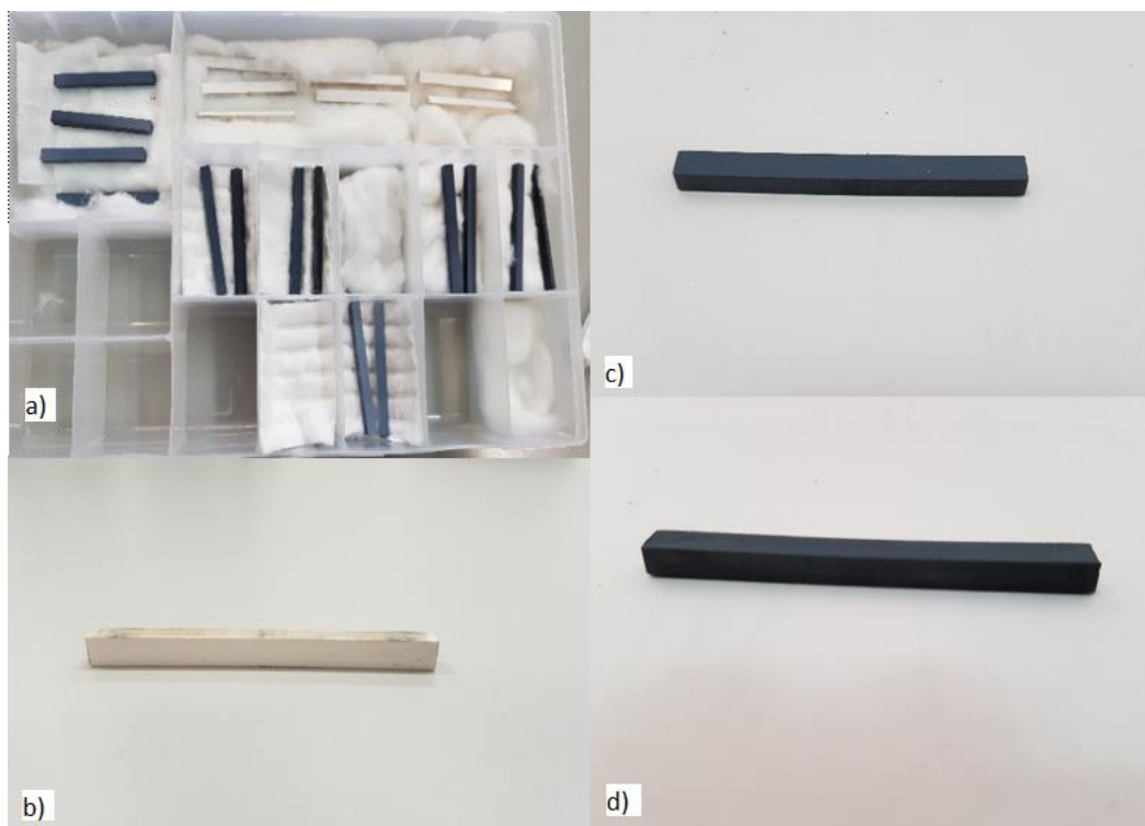
Figura 44: a) barras pós prensagem organizadas, b) barra prensada de zircônia pura, c) barra prensada com 1,0% NTC e d) barra prensada com 2,0% NTC.
