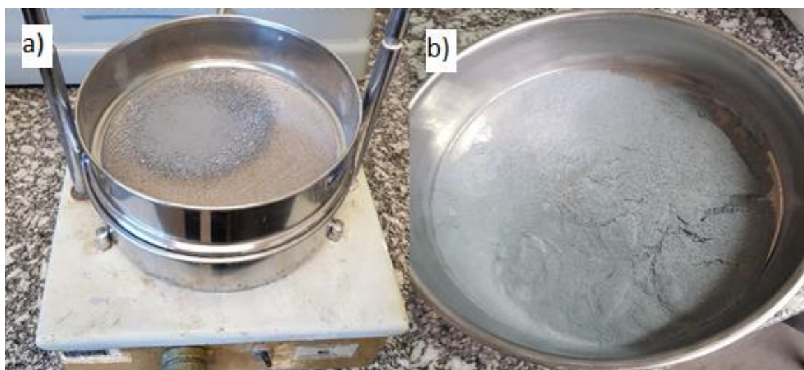
Figura 35: a) Peneira com o pó compósito posicionada no agitador mecânico e b) pó após a agitação e peneiramento.
