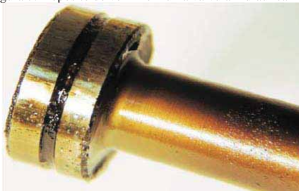
Figura 7: Depósito de verniz em uma válvula hidráulica
