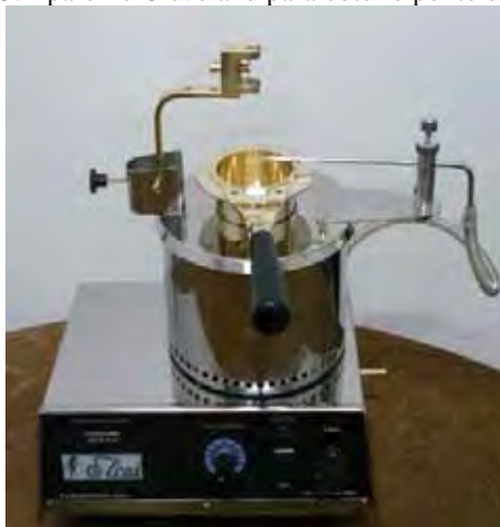
Figura 13: Aparelho Cleveland para obter o ponto de fulgor.
