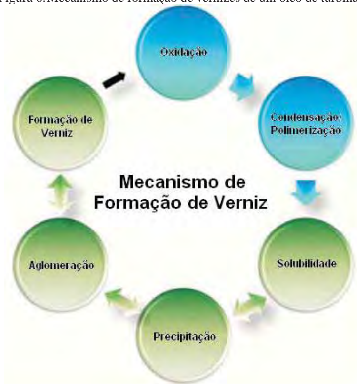
Figura 6: Mecanismo de formação de vernizes de um óleo de turbina a gás.
