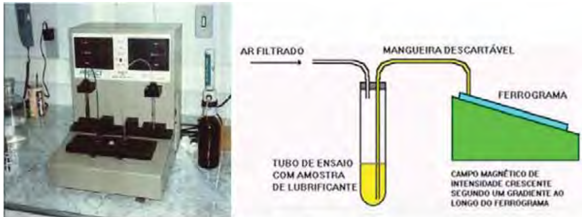
Figura 25: Ferrógrafo analítico FM III, juntamente com seu princípio de funcionamento.
