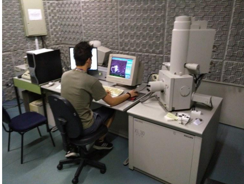
Figura 23 - Microscópio eletrônico de varredura Phillips XL-30 FEG
