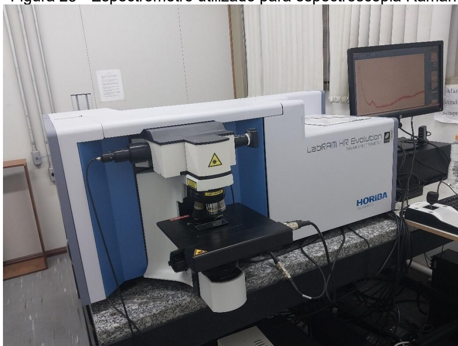
Figura 25 - Espectrômetro utilizado para espectroscopia Raman
