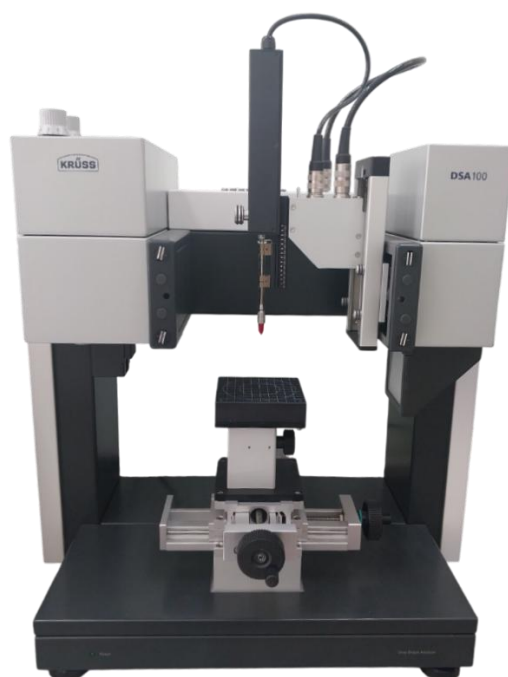
Figura 24 - Goniômetro utilizado para medição do ângulo de contato
