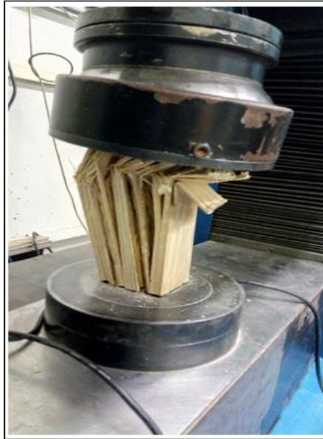
Figura 52 - Ruptura do corpo de prova à compressão paralela às fibras.
