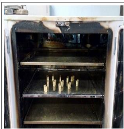
Figura 47 – Corpos de prova de Bambu scrimber na estufa de secagem.
