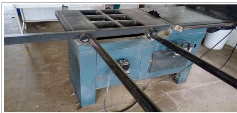
Figura 22 – Serra circular utilizada para seccionamento dos colmos no comprimento.
