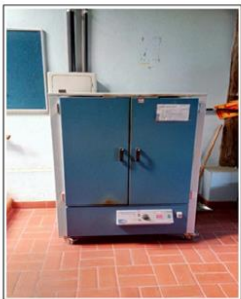
Figura 27 – Estufa de secagem com circulação de ar.
