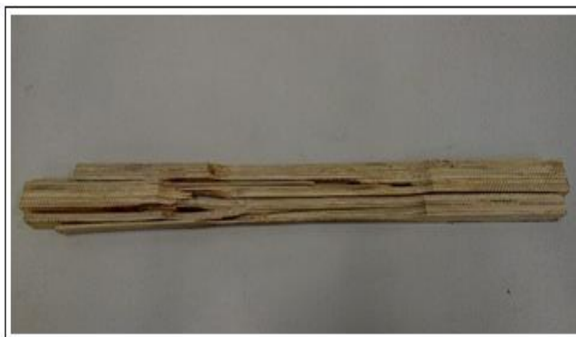
Figura 64 – Exemplo de rompimento sofrido pelo corpo de prova à tração paralela às fibras.
