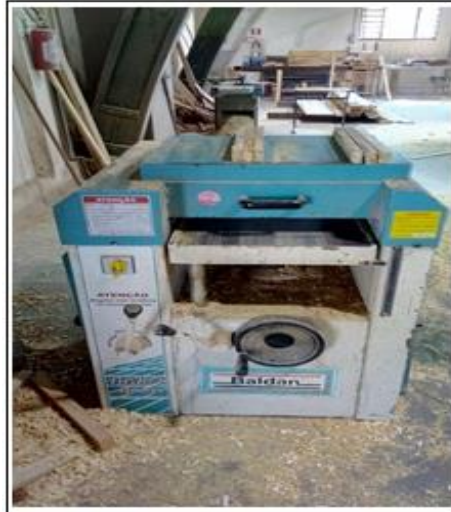
Figura 37 – Blocos de Bambu scrimber usinados na desengrossadeira.
