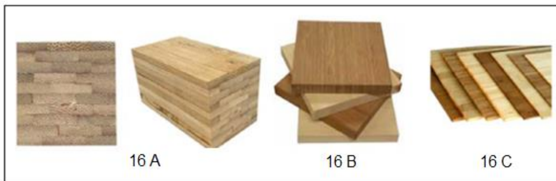
16 A) Bambu laminado colado (Fonte: Pereira, 1997); 16 B) BLC, com duas camadas verticais. (Fonte: http://zenbamboo.com , 2006); 16 C) BLC com uma camada. (Fonte: http://www.cbamboo.com 2006) apud Moizés, (2007).
