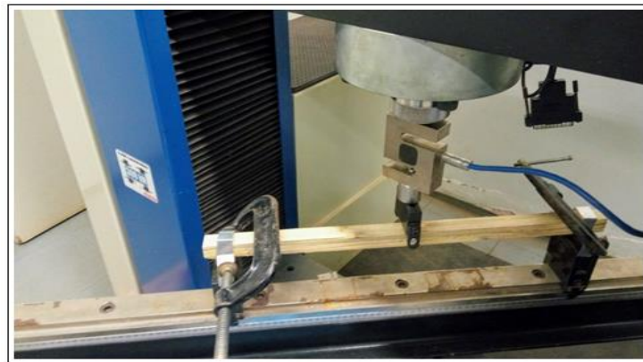
Figura 58 – Ensaio mecânico de um corpo de prova com flexão estática.
