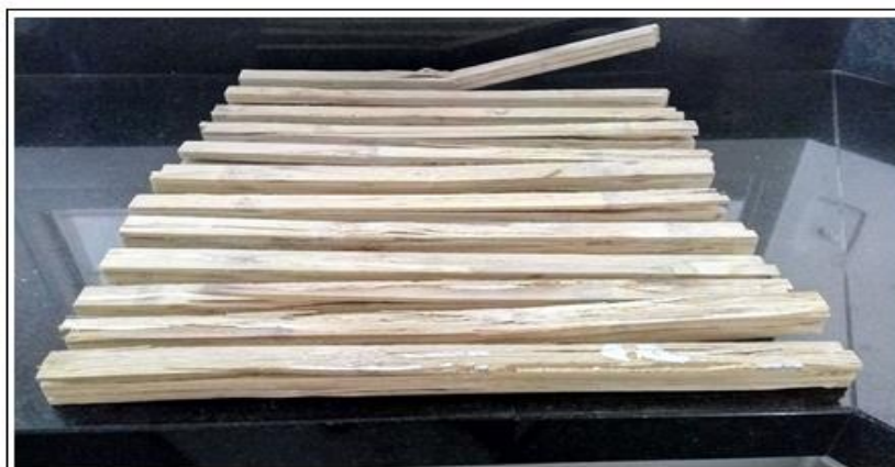
Figura 65 – Deformações sofridas pelos corpos de prova à flexão.
