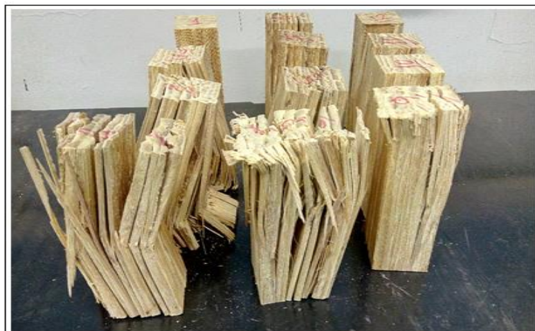
Figura 63 - Corpos de prova que sofreram ruptura à compressão.
