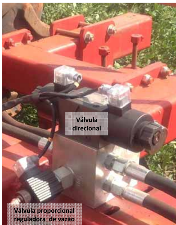
Figura 18. Bloco manifold do sistema eletrohidráulico.
