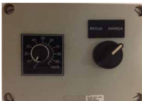
Figura 20. Potenciômetro e botão para o controle de rotação da esteira vibratória.
