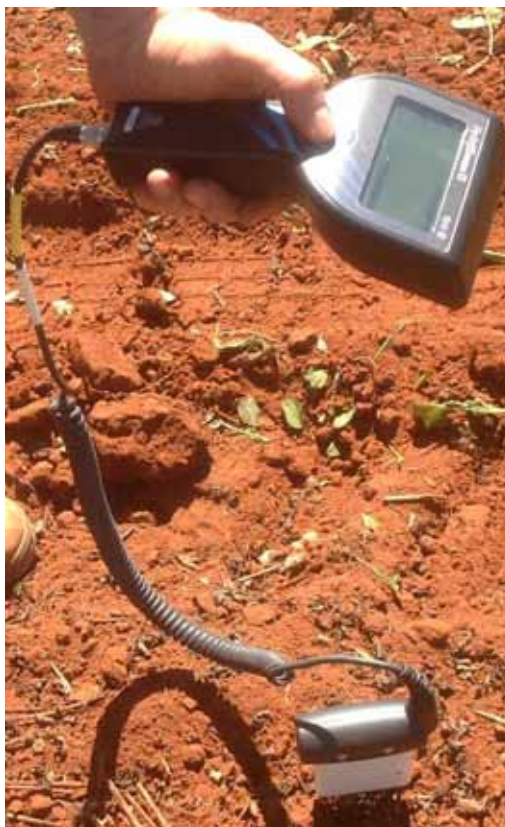
Figura 27. Determinação do teor de água do solo utilizando Reflectometria no Domínio do Tempo (TDR).
