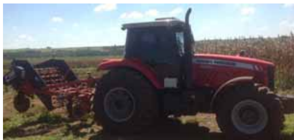
Figura 26. Equipamentos utilizados no arranquio de amendoim: conjunto mecanizado trator MF 7180, 4x2 TDA e arrancador-invertedor.
