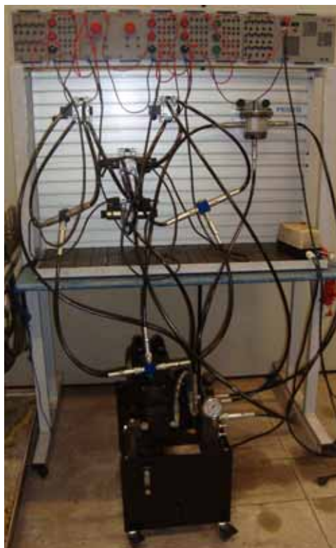
Figura 23. Circuito eletrohidráulico para simulação das diferentes rotações.
