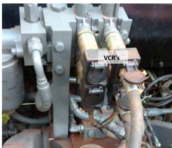
Figura 17. Exemplo das válvulas de controle remoto (VCR's) de um trator.
