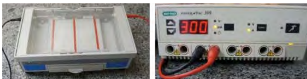
Figura 11 – Cuba de eletroforese 25 V (0,86 V/cm) e 300 mA.
