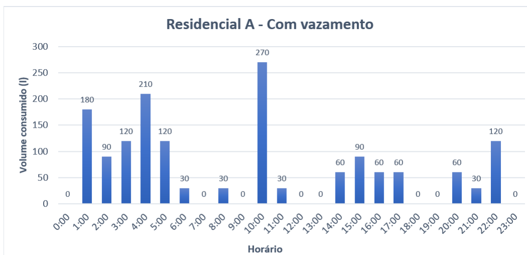
Figura 5.4 – Consumo de água em dia com vazamento para o consumidor Residencial A.
