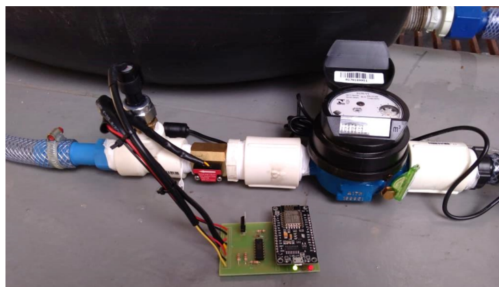
Figura 4.13 – Detalhe da montagem dos sensores e da conexão com a placa.
