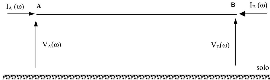
Figura 3.3 – Linha de transmissão monofásica de comprimento  $d$ .
