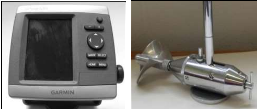
Figura 16. Instrumentos e equipamentos utilizados em campo A) Sonar Garmin para determinação de largura e profundidade; B) Molinete hidrométrico para determinação de velocidade de fluxo
