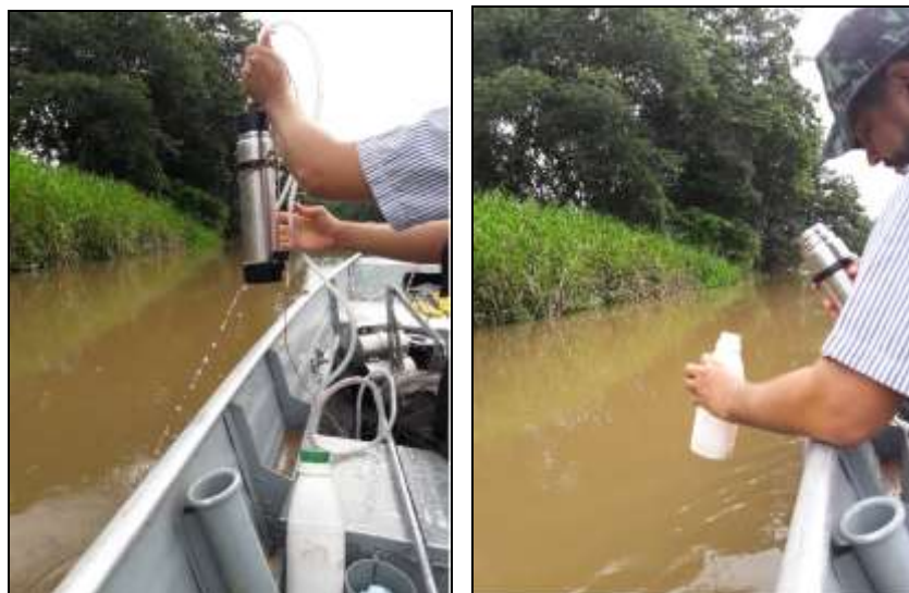
Figura 20. Procedimento de coleta e armazenamento de material em suspensão Fotos: LEANDRO, Gustavo Roberto dos Santos (2017)
