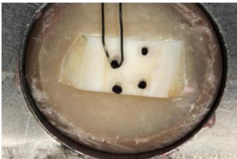
Figura 2 – Corpos de prova preparados para realização do teste de microcisalhamento
