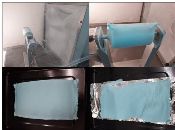
Figura 10. Fibras poliméricas da solução precursora ácido acrílico 15%/hidróxido de amônio 25%/metanol 60%.
