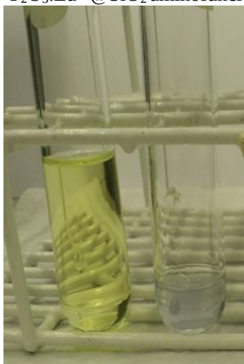
Figura 60. Solução de ninidrina (5 % m/v em etanol) e solução contendo o composto de Ruhemann obtido pela reação de Y_2O_3:Eu^{3+}@SiO_2 aminofuncionalizada com ninidrina.
