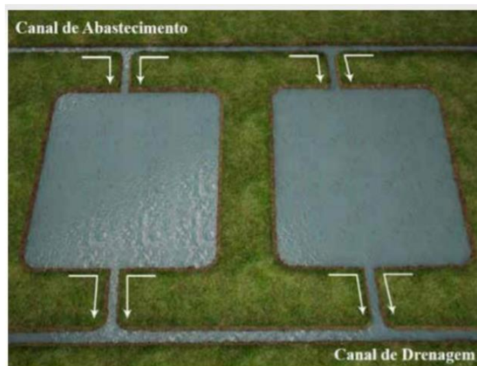
Figura 36 – Sistema de abastecimento e drenagem de viveiros de produção.
