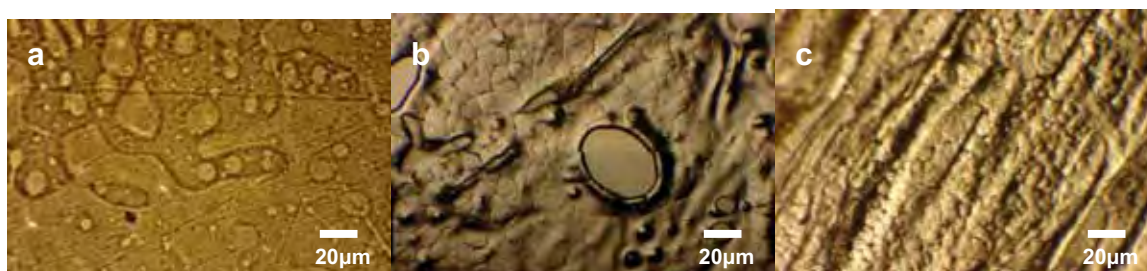
Figura 11: Blenda de PHB/PP (a) original; (b) e (c) biotratada em efluente bruto por 120 dias.
