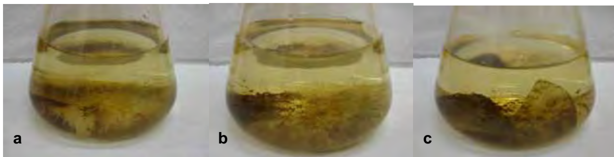
Figura 9: Blendas de PP/PHB em água do rio Atibaia após 120 dias de biotratamento: (a) antes do descarte do efluente, (b) após o descarte do efluente e (c) efluente bruto.
