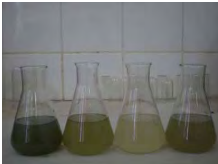
Figura 46 – Foto do efluente bruto, UASB, BF1 e BF2, respectivamente
