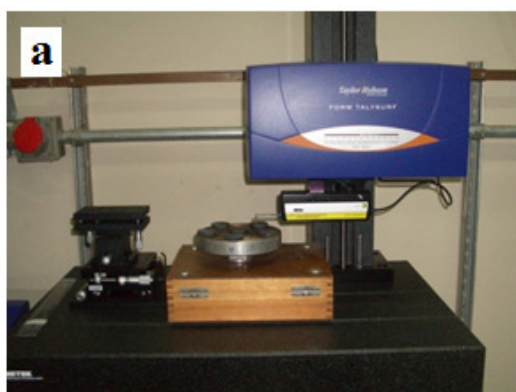
Figura 37 - (a) Fotografia do rugosímetro e (b) Parâmetros de rugosidade
