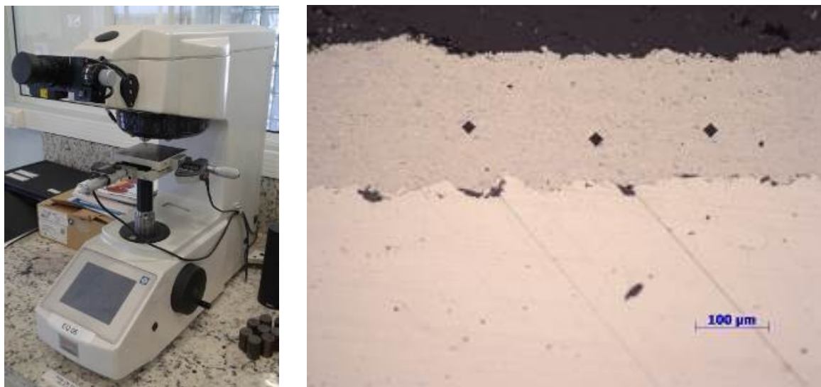
Figura 33 – Fotografia do equipamento utilizado na medição de dureza à esquerda e imagem representativa da indentação no revestimento.
