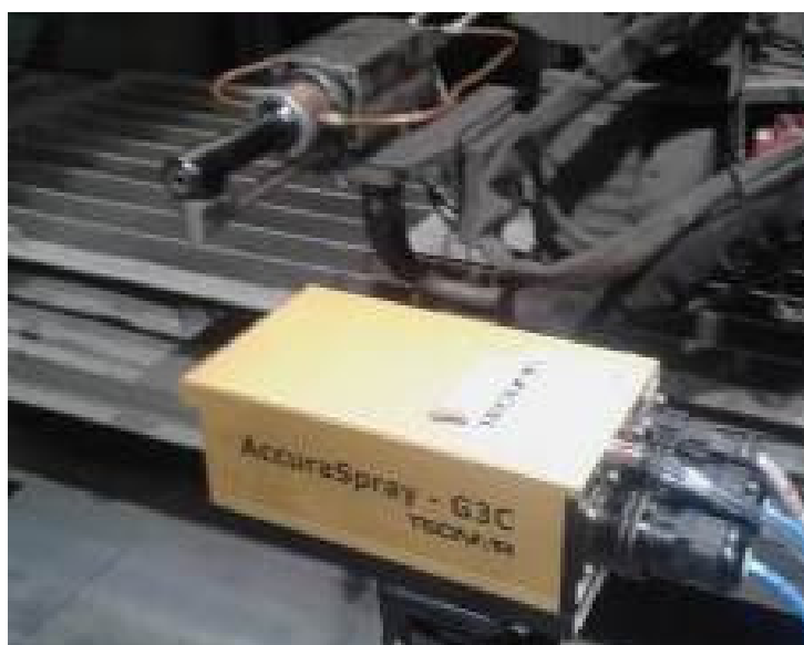
Figura 22 - Fotografia do equipamento de medição da temperatura e velocidade da partícula AccuraSpray G3C.
