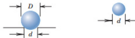
Figura 31 - Representação esquemática da medição de dureza Brinell, sendo D o diâmetro da esfera e d o diâmetro da indentação.
