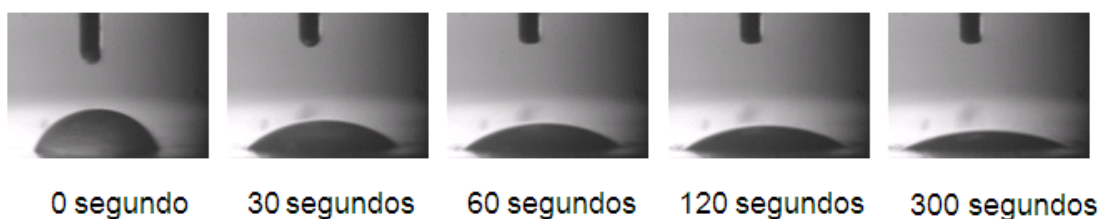
Figura 28 - Ilustração da gota d'água sobre o biofilme com ácido oléico para medidas de ângulo de contato nos tempos 0, 30, 60, 120 e 300 segundos.
