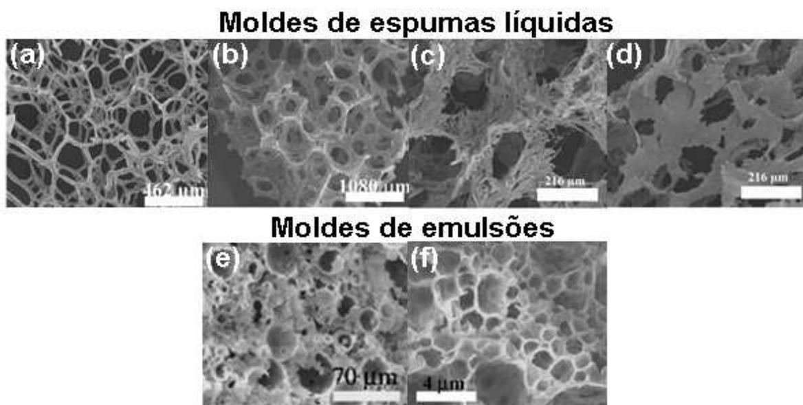
**Figura 10.** Micrografias de materiais preparados a partir de moldes de (a-d) espumas líquidas e (e-f) emulsões: (a) e (b)  $\text{TiO}_2$  com diferentes fluxos de sol no sistema; (c) e (d)  $\text{TiO}_2$  com diferentes tempos de envelhecimento do sol; (e) e (f) sílica preparada com diferentes pHs no sistema emulsivo. (adaptado <sup>3; 52; 53</sup>)
