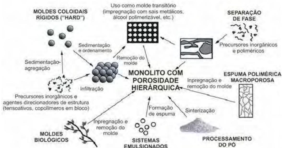
**Figura 4.** Esquema dos processos de preparação de cerâmicas com porosidade hierárquica (adaptado de Colombo et al. <sup>6</sup>).
