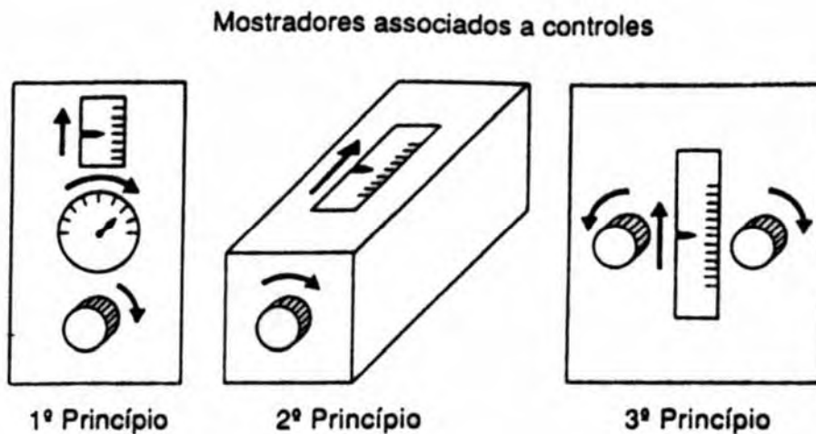
Figura 28 - Figura dos princípios da associação dos movimentos de mostradores com os dos controles.
