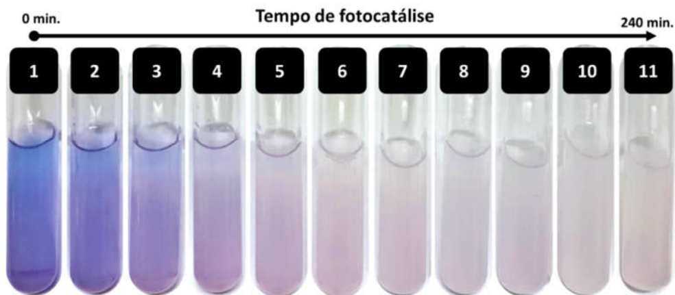
Figura 5.34. Imagem das alíquotas obtidas durante o ensaio fotocatalítico do catalisador K_{0,2}Na_{0,8}NbO_3 na descoloração do corante Basic Blue 41 em pH 10,0.
