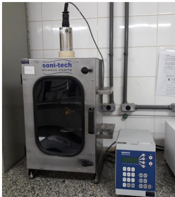
Figura 8. Ultrassom de ponta utilizado para a dispersão da cloisite Na +
