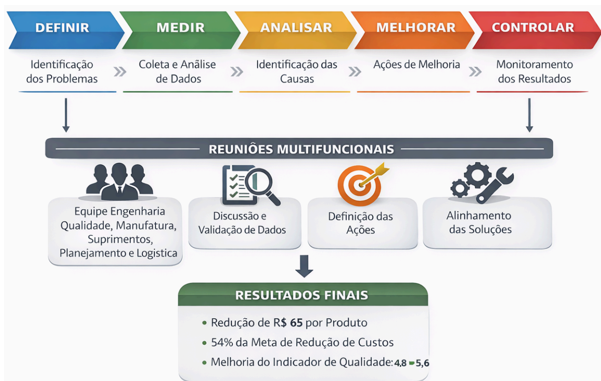
Figura 5: Fluxo de aplicação da metodologia Six Sigma (ciclo DMAIC) no estudo de caso.
