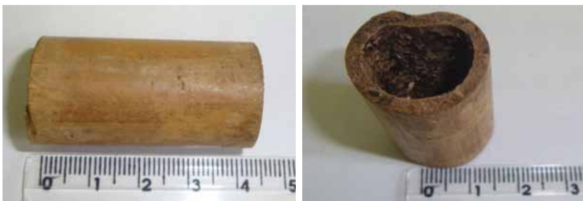
FIGURA 6. Anéis de bambu utilizados como meio suporte no FAS (medidas em cm)
