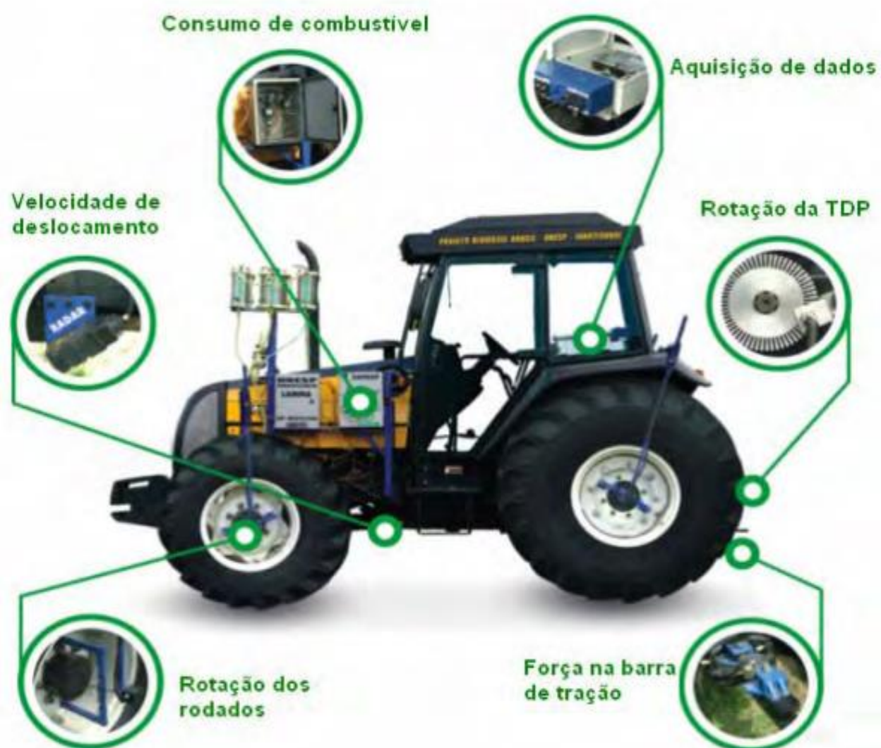
Figura 1. Vista lateral do trator de teste com instrumentação completa (Lopes, 2006).
