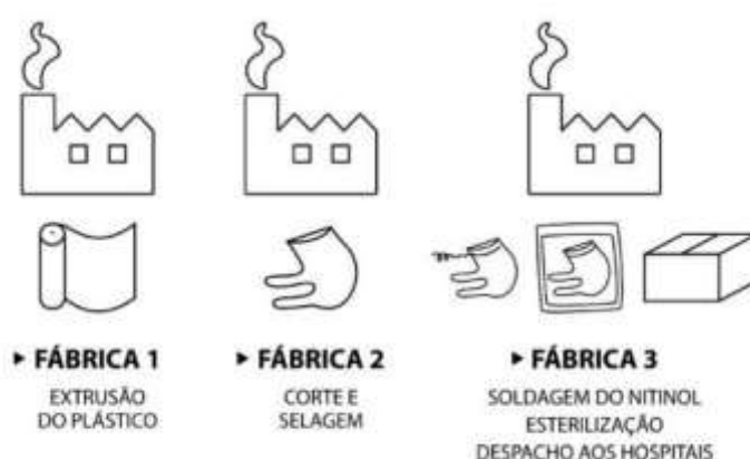
Figura 68: Processo de fabricação da bolsa de morcelamento.
