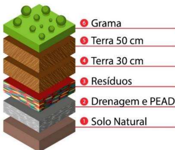
Figura 74: Sistema de camadas projetadas do aterro sanitário.
