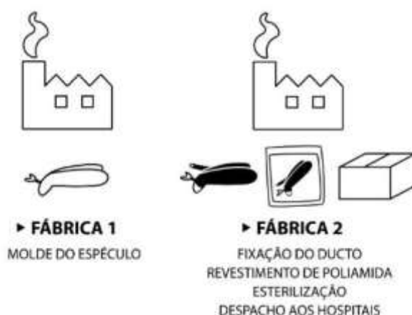
Figura 59: Processo de fabricação do espécuro vaginal cirúrgico.
