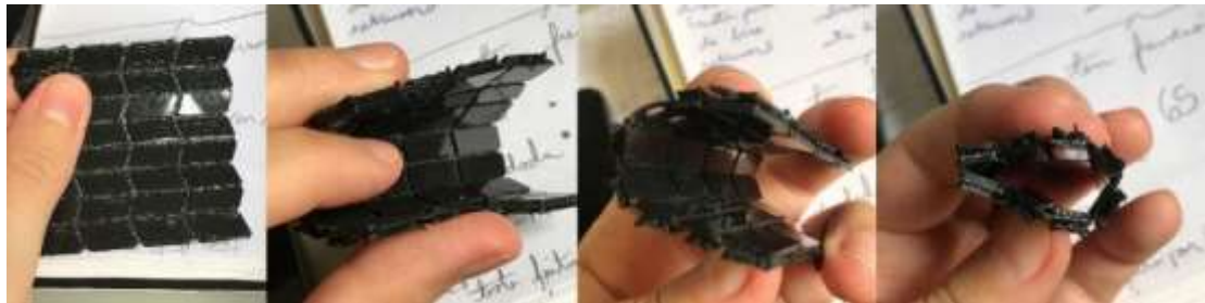
Figura 138: Impressão do Miura-Ori com o encaixe macho e fêmea.
