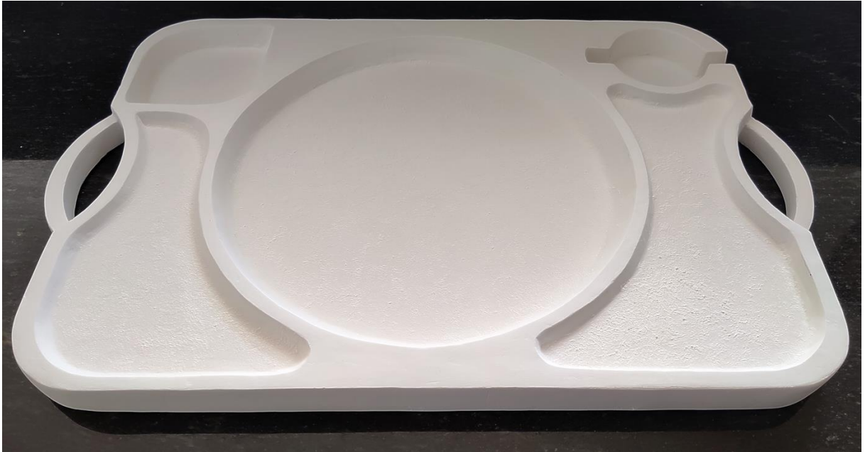
Figura 44 – Mockup físico após acabamento e aplicação de efeito texturizado
