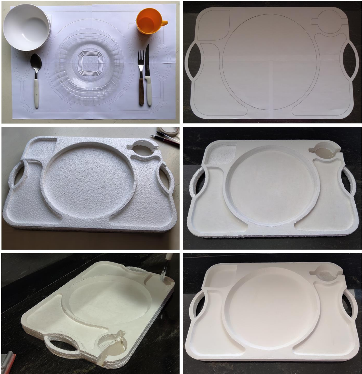
Figura 43 – Processo de produção do mockup físico
