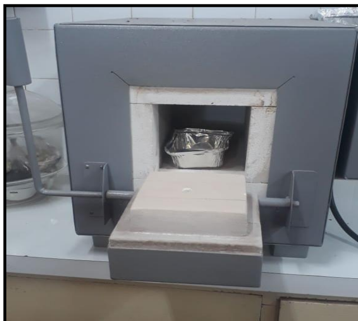
Figura 13: Mufla usada para calcinação de filtros.
