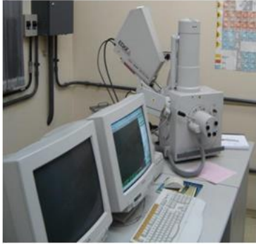
Microscópio Eletrônico de Varredura MEV-PHILIPS (XL-30 FEG, Philips) + Microsonda de EDS acoplamento interno.
