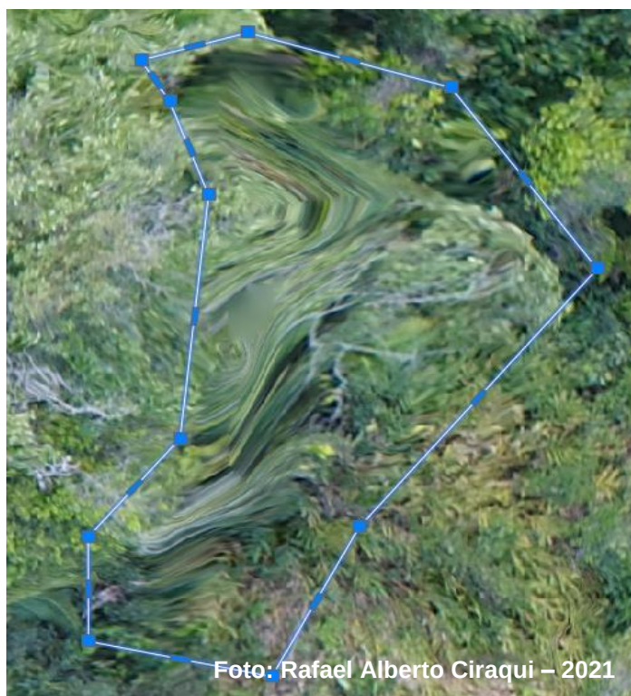
Figura 16 – Vetorização de distorção/deformação no ortomosaico
