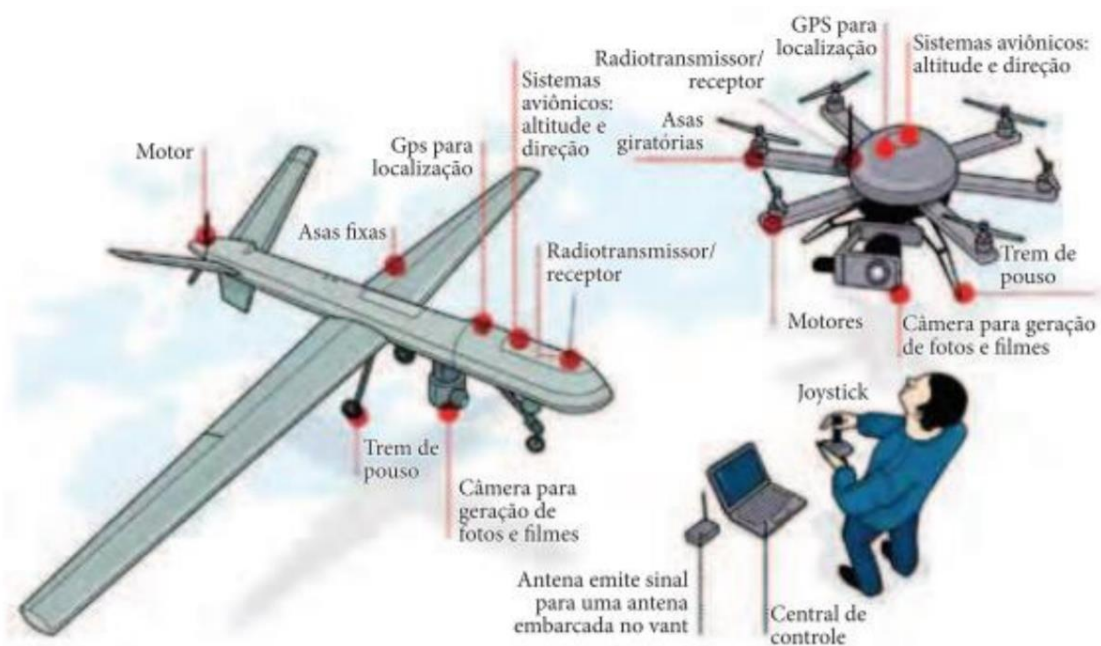
Figura 3 – Diferenças entre ARPs de asa fixa e asa rotativa
