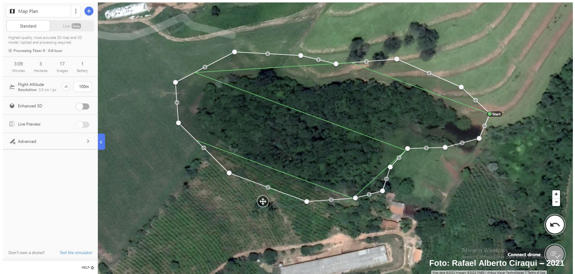
Figura 13 – Plano de voo na interface do software DroneDeploy (configurações básicas)
