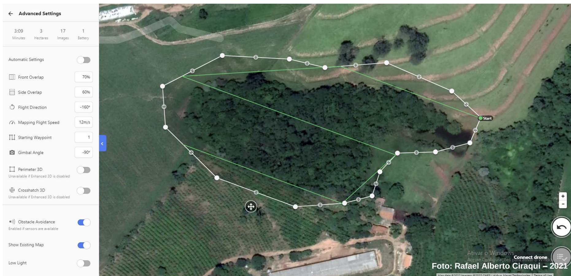
Figura 14 - Plano de voo na interface do software DroneDeploy (configurações avançadas)
