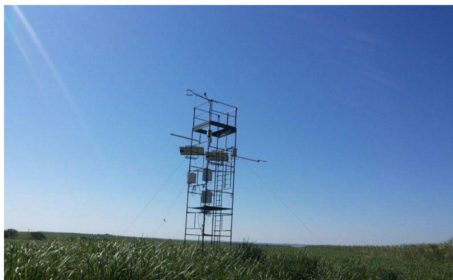
Figura 2 – Torre Eddy Covariance instalada em cana-de-açúcar no Noroeste Paulista
