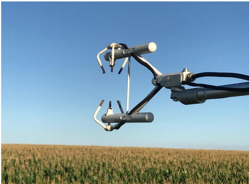
Figura 3 – Anemômetro sônico tridimensional integralizado com analisador de gás IRGASON®
