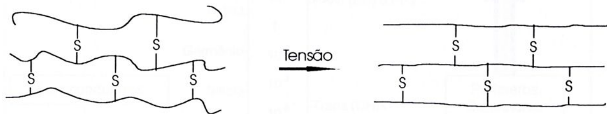
Figura 4 - Vulcanização da borracha.
