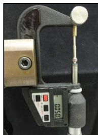
Micrômetro eletrônico digital com saída acoplado a uma base de microscópio e blocos fixados
