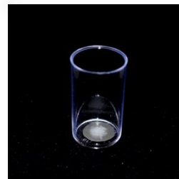
Desgaste ~50µm Lixa 400 (CARBIMET - BUEHLER)
