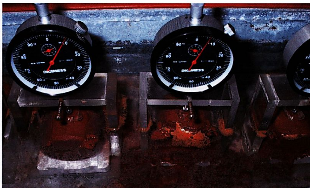
Figura 16: Corpos de prova de solo sem aglomerante que apresentaram perda de massa quando submersos
