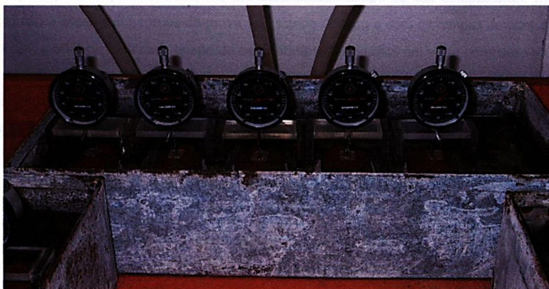
Figura 15: Medição da expansão diametral dos corpos de prova
