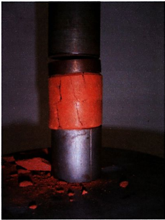
Corpo de prova rompido
