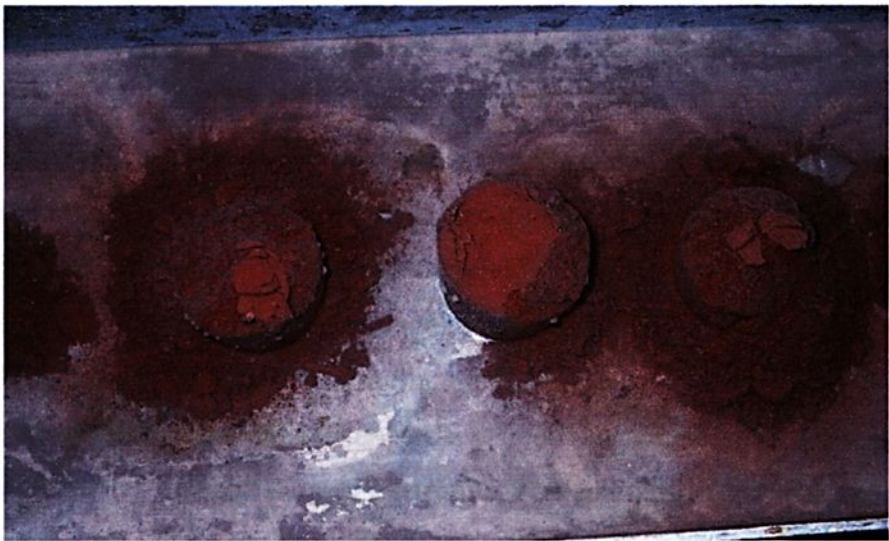
Figura 26: Corpos-de-prova de solo-cal imersos imediatamente após a moldagem.
