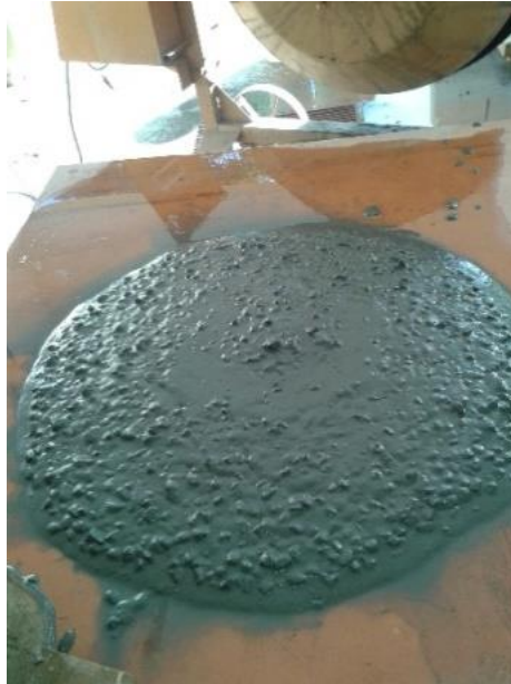
Figura 14 - Ensaio de espalhamento Slump-Flow para o concreto autoadensável
