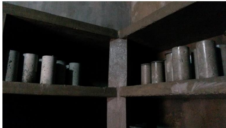
Figura 13 - Acondicionamento dos corpos de prova em câmara úmida
