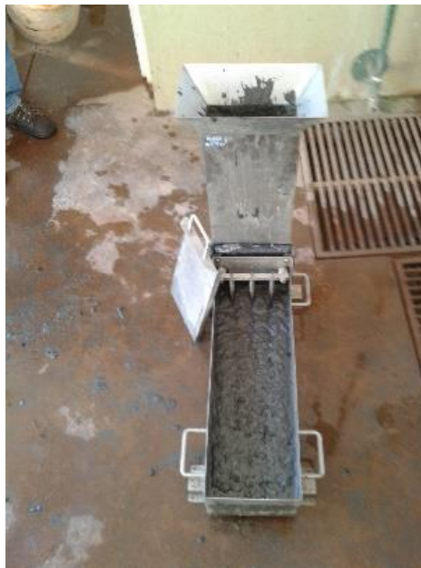
Figura 15 - Ensaio da caixa em L
