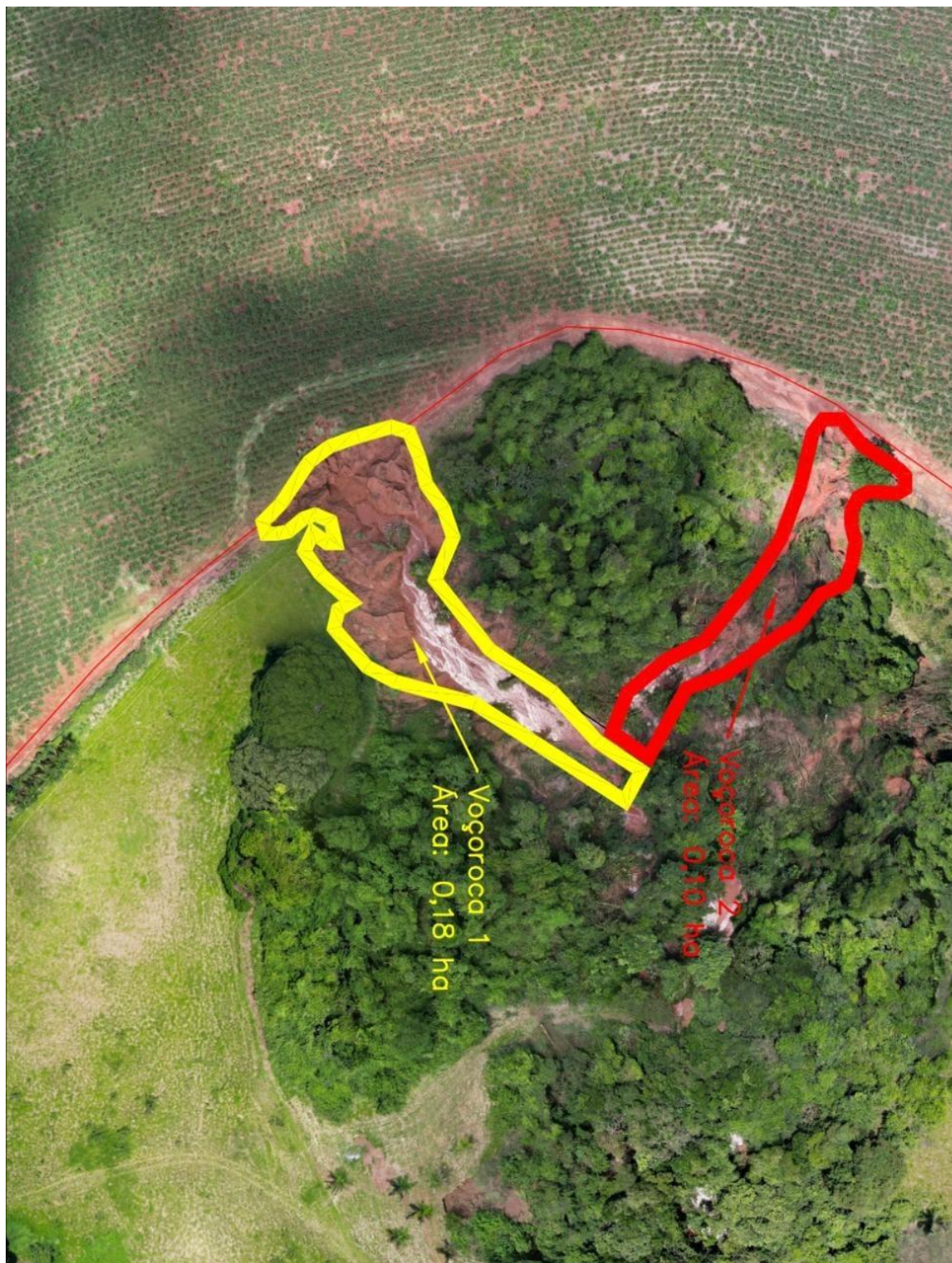
Figura 1. Imagem aérea das voçorocas 1 e 2 em área de APP.
