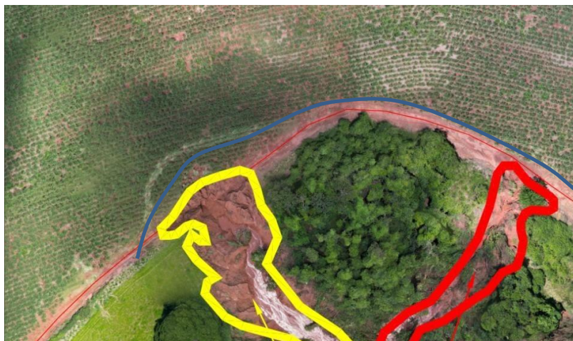
Figura 10. Terraço embutido complementar no entorno às voçorocas (linha azul).
