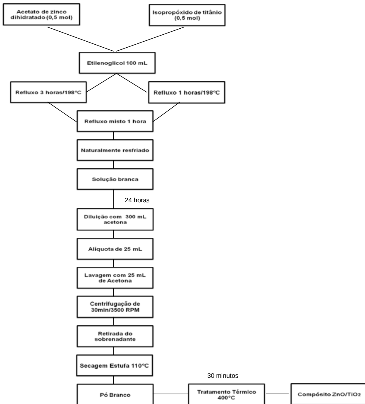
Figura 5.2: Fluxograma de síntese para obtenção do compósito ZnO-TiO 2 pelo Método Poliol.
