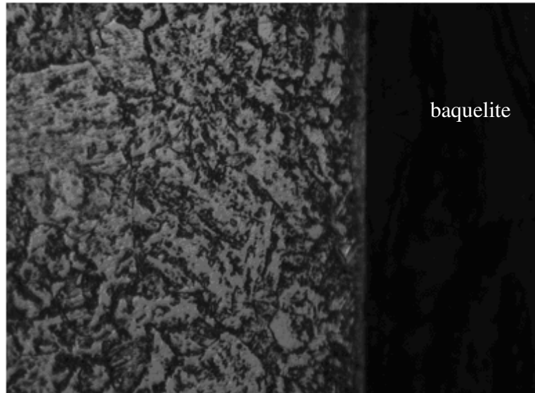
Figura 4.19 - Nitrocarbonetação de metal base Recozido – Ampliação 500x.
