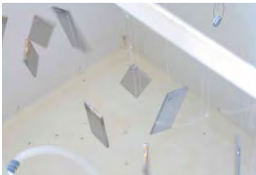
Figura 4.77 – Amostra na câmara de salt-spray
