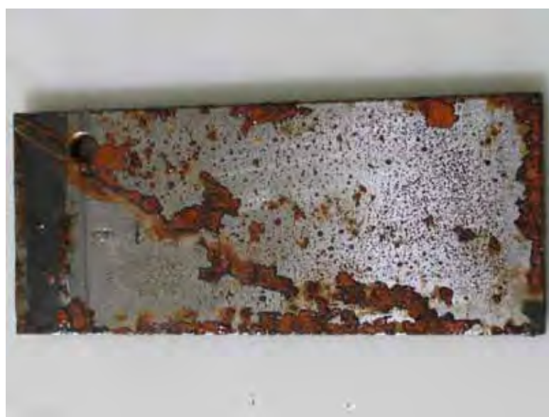
Figura 4.79 – Salt - Spray 24h – Corrosão vermelha – Detalhe.
