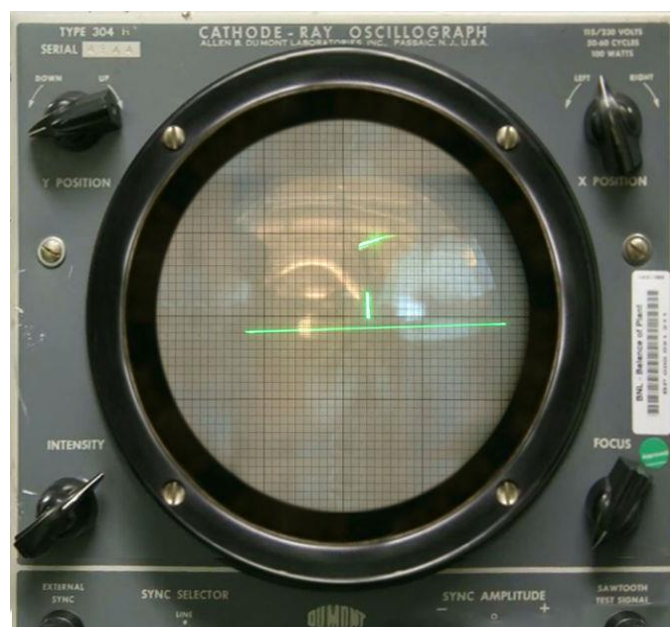
Figura 2 - “ Tennis for Two ” em um osciloscópio DuMont Lab tipo 304 – A.
