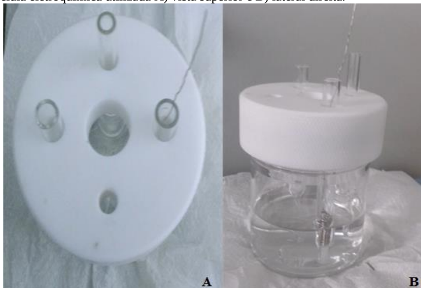
Figura 14. Célula eletroquímica utilizada A) vista superior e B) lateral direita.
