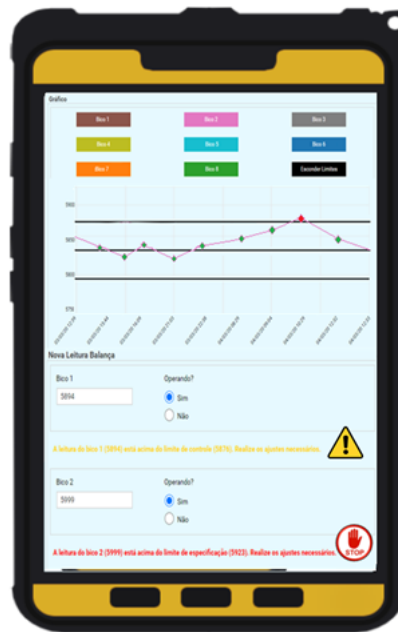
Figura 35 – Central de controle estatístico do processo (Skelta®)
