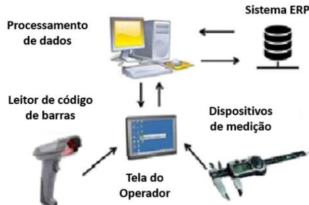
Figura 24 – Esquema do sistema de medição
