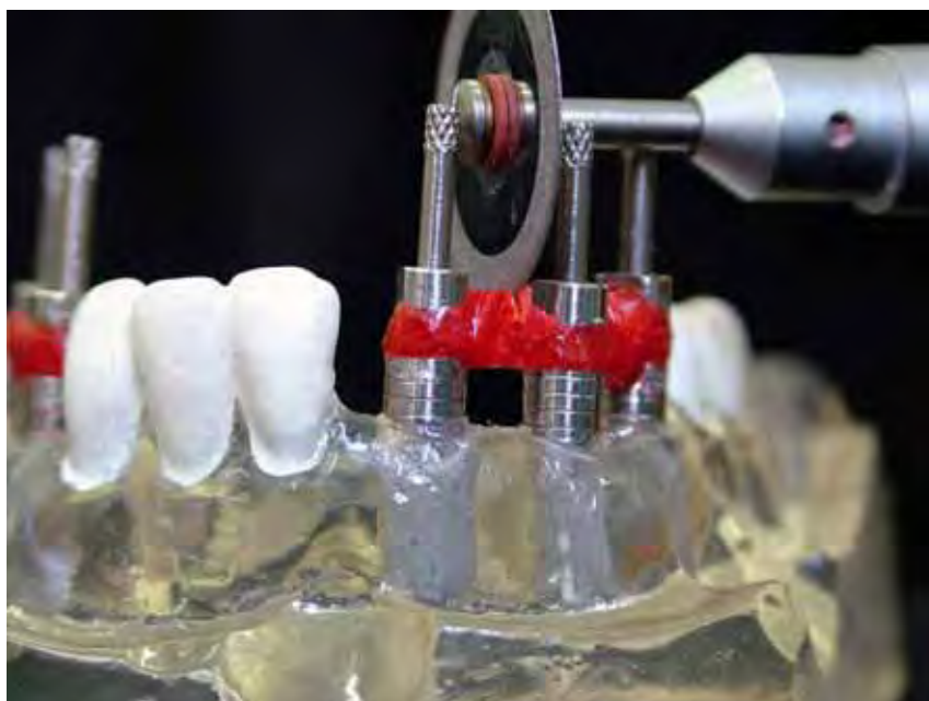
FIGURA 19 – Corte com o disco diamantado com 150 \mu m de espessura.
