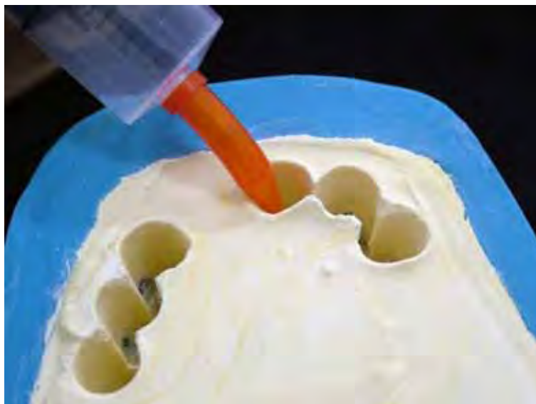
FIGURA 37 – Método empregado para injetar o gesso no interior dos espaços criados.
