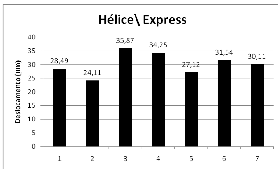
FIGURA A9 – Gráfico com as médias dos valores dos deslocamentos ( \Delta R ) mensurados em cada um dos sete modelos obtidos a partir das moldagens com transferentes Hélice Express.
