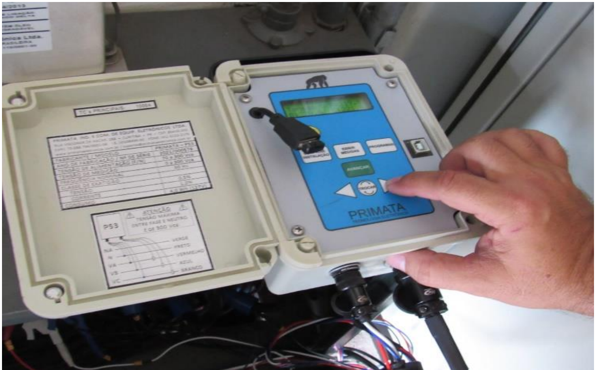
Figura 30: Configurando o analisador de energia.
