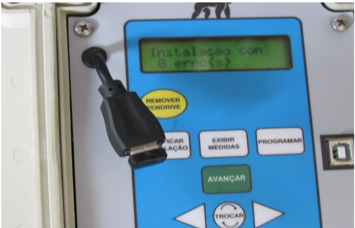
Figura 31: Analisador de energia sem erros para fazer as medições.
