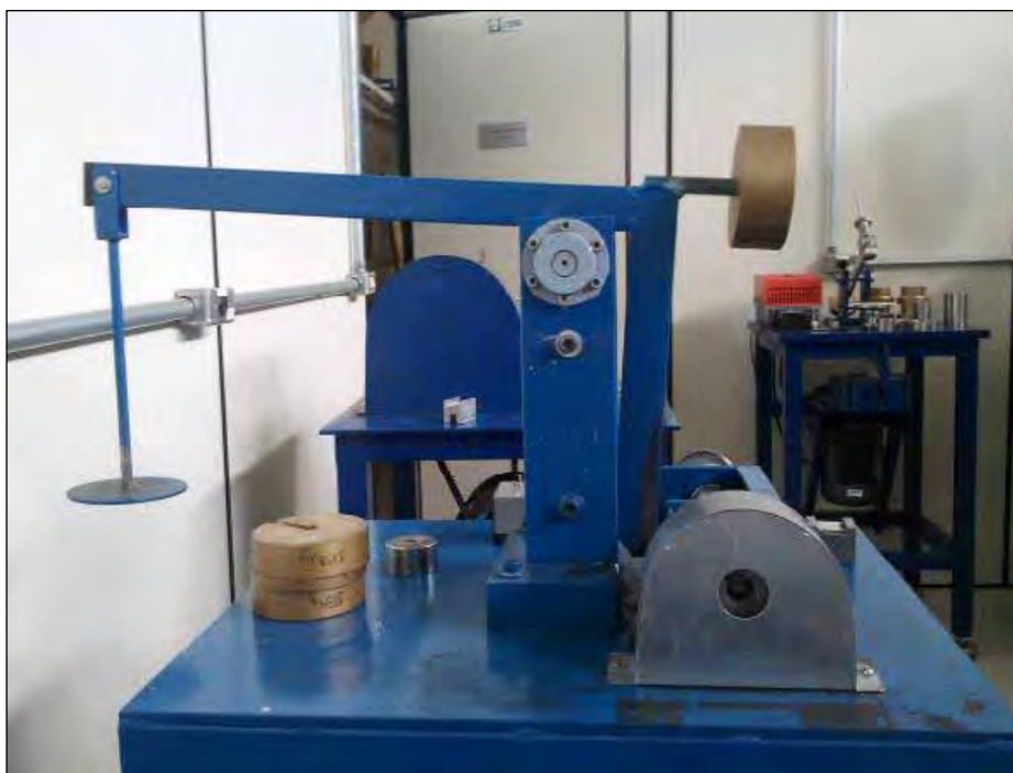
Figura 23 – Foto do equipamento utilizado para realização do ensaio tribológico esfera sobre placa.
