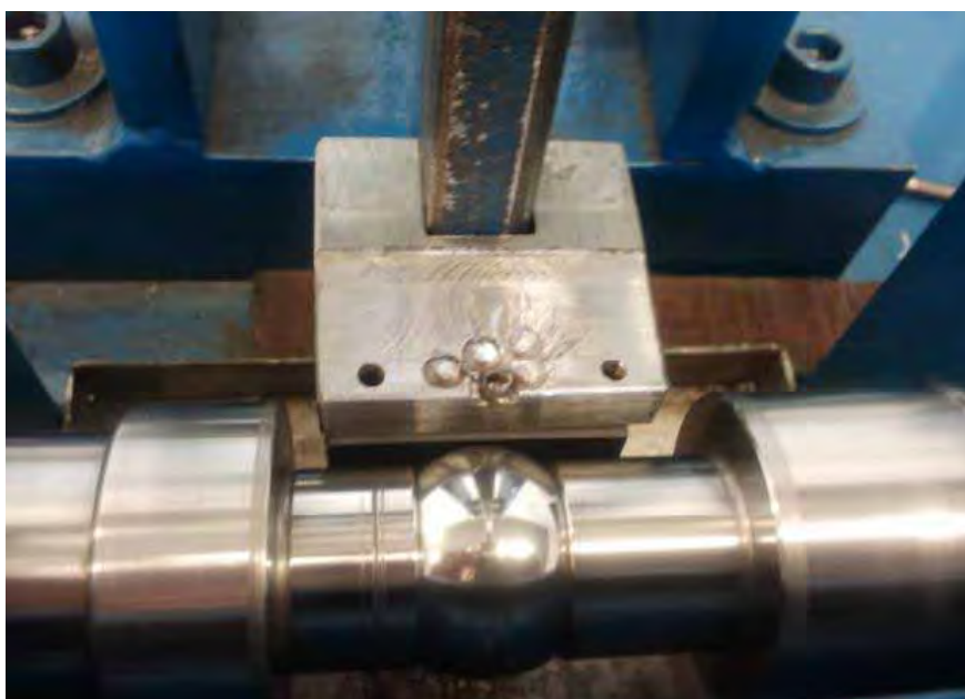
Figura 24 – Esfera (contra corpo) em contato com a amostra do compósito polimérico (corpo de prova).
