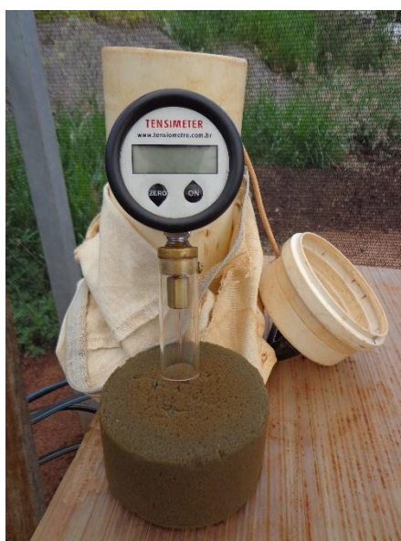
Figura 10. Tensímetro utilizado para leitura das tensões do teor de água no solo.
