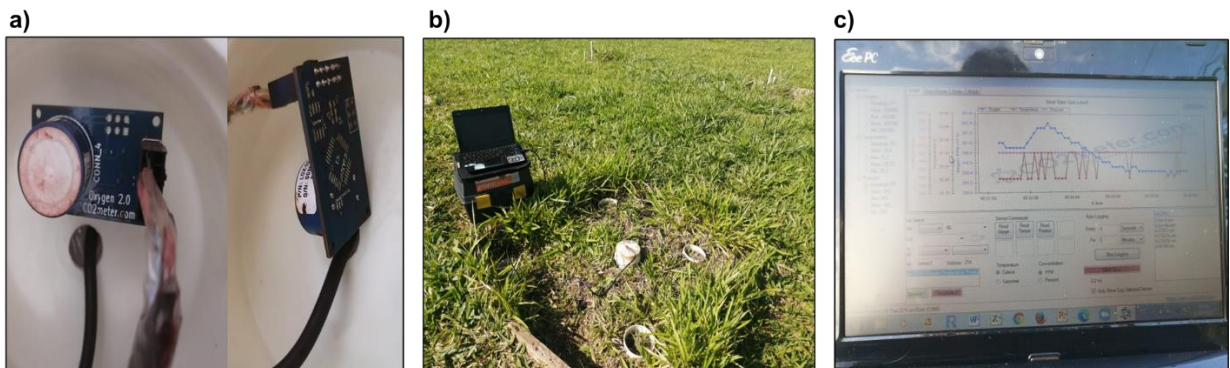
Figura 5. Equipamento utilizado para a medição da captura de oxigênio no solo: (a) Sensor de oxigênio UV Flux 25%. (b) Sensor acoplado no anel do solo e ao computador. (c) Software Gaslab mostrando o influxo de O_2 em tempo real (gráfico com coloração azul).
