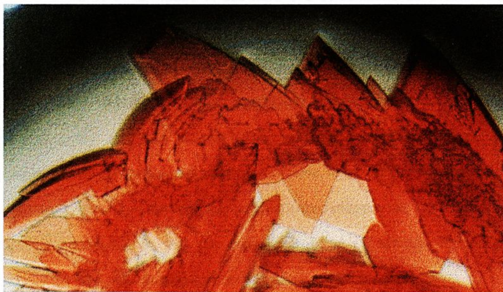
Figura 23. Cristal crescido como massa policristalina.
