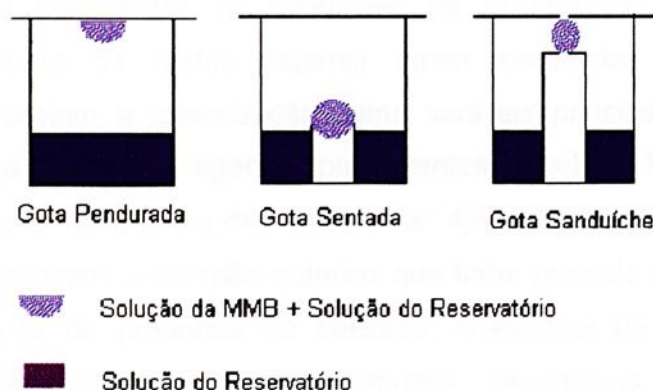
Figura 27. Representação dos processos de Difusão de Vapor.
